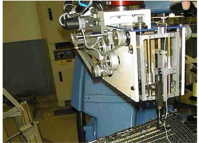
Fig. 10 Tufting Head
